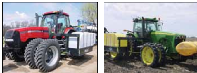
Figure 2. Tracteurs Case IH et John Deere équipés de réservoirs pour l'application de l'engrais liquide au semis.
